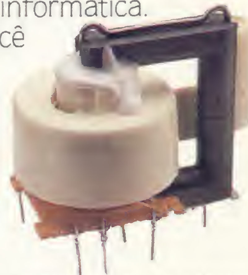
Transformador de Saida Horizontal
